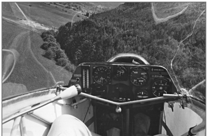
Haubenverriegelung: Ein drehbarer Querstab der in zwei Bolzen am Rumpf einrastet
